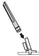
※ノズルの口径に合わせて、付属品ホルダーの長いフック、または両方のフックに差し込む。どちらか安定する方で差し込んでください。
