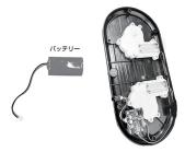
6. 逆の手順で組み立てます。 組み立て時、バッテリーのコード、 充電口、の順で組み立てて下さい。
