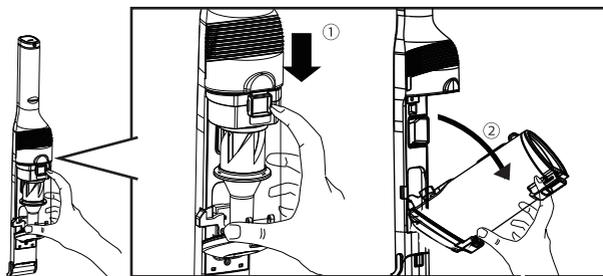
上図のようにダストカップを持ち、人差し指で①のボタンを押しながら、②後ろに倒すようにしてダストカップを取り外す。
