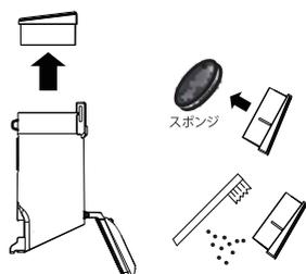
ダストカップからHEPAフィルターを外し、HEPAフィルターからスポンジを外します。歯ブラシなどでフィルターの隙間に詰まった埃を取り除きます。
