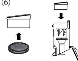
HEPAフィルターにスポンジを入れて、ダストカップ上部に取り付けます。
