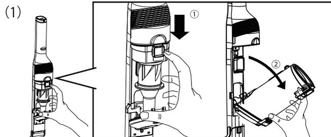
上図のようにダストカップを持ち、人差し指で①のボタンを押しながら、②後ろに倒すようにしてダストカップを取り外す。
