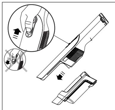
②ダストカップを外して、ゴミを吸わずに空運転させて、稼働する場合:ゴミつまりにてモーター保護のため停止しています。下記のゴミつまりの確認をお願いします。
