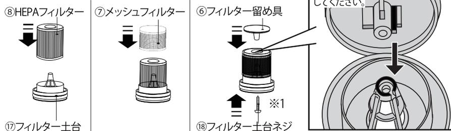
※1 フィルター土台ネジは強く締めすぎないでください。強く締めると破損する場合があります。
