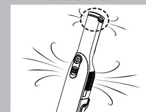
バッテリー接続部分からも排気することで、バッテリーの冷却効果を高めています。HEPAフィルター通過後のきれいな排気ですのでご安心下さい
