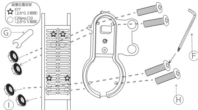
図を参考にして、掃除機の高さを確認し、上フレームにブラケット用ボルトで固定します。4つの穴にボルトがスムーズに入る場所を確認し、4つのボルトを仮止めしてからレンチとスパナでしっかりと固定してください。下部の2つのネジは差し込んだ後、ブラケットを左右に微調整しながらネジを差し込んでください。若干ネジが外に向く場合がありますが、ボルトでしっかりと締めて固定してください。
