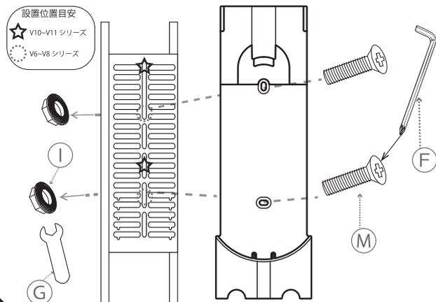
図を参考にして、掃除機の高さを確認し、上フレームにⓂダイソン用ボルトでしっかりと固定します。レンチとスパナでしっかりと固定してください。
