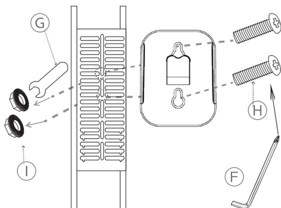
図を参考にして、掃除機の高さを確認し、上フレームにブラケット用ボルトで固定します。レンチとスパナでしっかりと固定してください。
