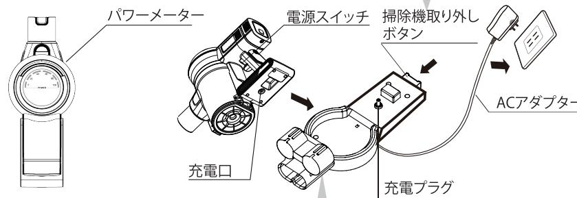
※壁掛けプラケットの裏側のネジを外し、プラケットからACアダプターを取り外してお使いいただくことも出来ます。
